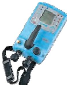
電子式圧力キャリブレーター
